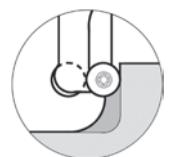
Фрезерование ребер жесткости
