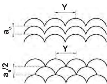
Схема обработки при нестабильных условиях
