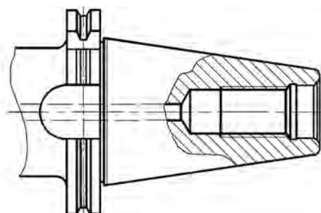
**NC...B** - Метрический конус 7/24 для станков с ЧПУ с центральной подачей СОЖ через фланец DIN 69871, форма B
