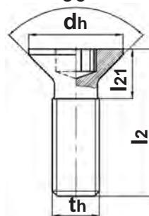
\* - Винт крепления кассет торцовых фрез.
