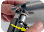
Разрезание оплетки методом вращения
